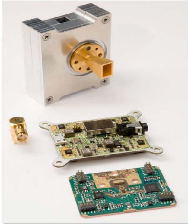
Basiskomponenten des Radarsensorsystems
